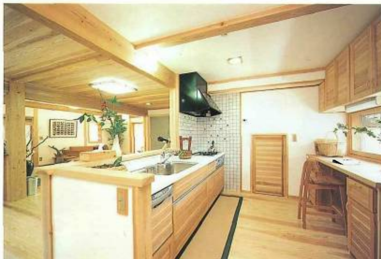
機能重視でデザインを後回しにしたがちなキッチンも家の雰囲気に合わせてアレンジが可能。杉材の建具やカウンターのお手入れは撥水性のよい自然オイルを塗るだけでなので、水回りにも無垢木を取り入れやすい
