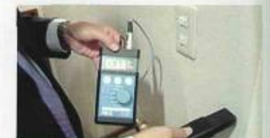
電磁波測定器で屋内配線から発生する電磁場が壁や床に帯電している様子が見える
