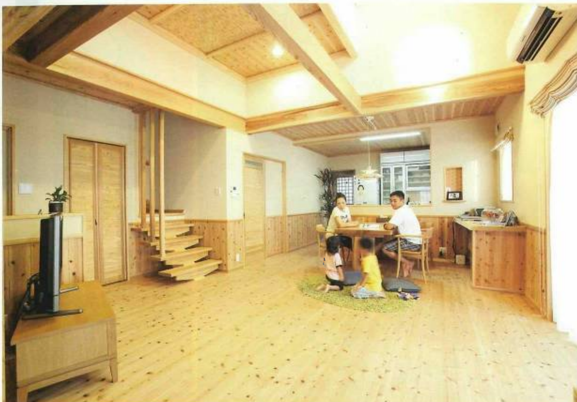
床、天井はすべて杉の無垢木、壁は珪藻土を使った天然素材に包まれた家。空気の流れて室温を調節できるエアバス工法で夏は涼しく、冬は暖かい空間に。廊下を作らない間取りは開放感がある。「杉の床はやわらかくてとても気持ちいい。子供たちも気に入っていて、よく寝ころんでゴロゴロしています」とYさん
