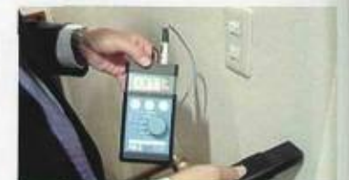
電磁波測定器で屋内配線から発生する電磁場が壁や床に帯電している様子分かる
